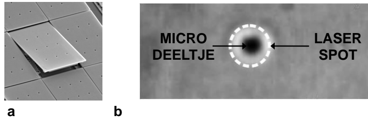
Figuur 1: a , 2D-matrix van verdraaibare microspiegeltjes. Eén van de spiegeltjes bevindt zich in de ‘actieve’ geroteerde toestand. (foto van Sandia National Laboratories), Een microdeeltje, gevangen in het centrum van een laserspot.
